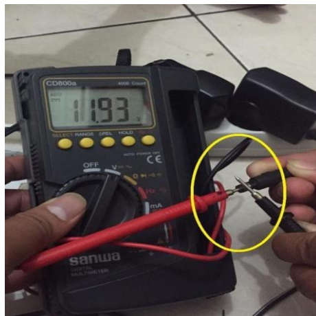
Gambar 4.3 Pengujian Output Adapter 12V
