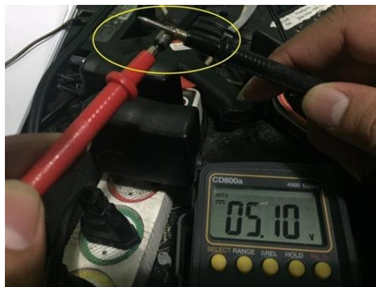
Gambar 4.2 Pengujian Output Adapter 5V
