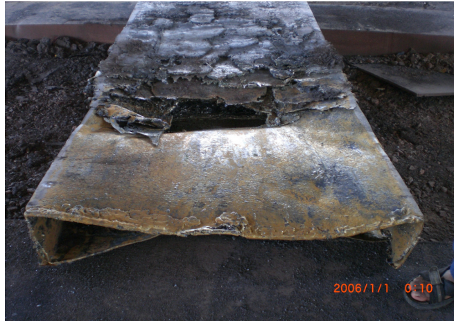
Gambar 2. Breakout Kulit Baja Slab Yang Pecah (dok.pri.)
