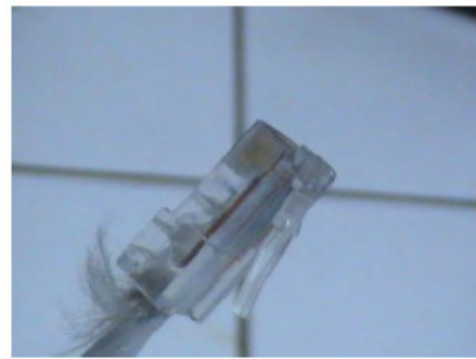
Gambar 3.8. (a) Contoh ujung yang terputus (b) Contoh sambungan yang baik
